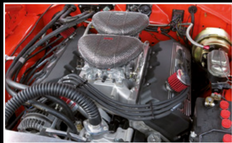
Anders Wembratt från Gråbo kom till AmericaFesten i sin fina -69 Charger utrustade med en potent Hemimotor. Dock ingen original 426 utan en modern version med Stage 5 Hemitoppar monterade på ett "big block" motorblock. Volymen är 472 kubiktum. Chargern är faktisk såld ny i Danmark vilket måste va extremt ovanligt! Anders bil håller verkligen toppklass och fick 3:e pris i Street Machine klassen!
